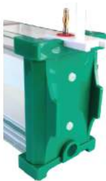
扳手紧固方式，制胶、上板轻松快捷
